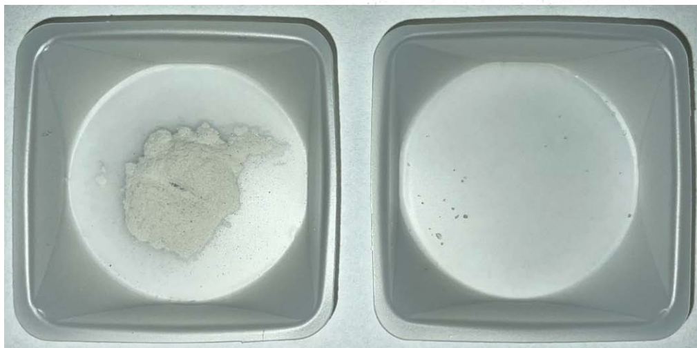
Bild 1: Darstellung der Mengen von 99 Gew.-% P3A (links) und 1 Gew.-% FH31 (rechts) zur Verdeutlichung des Anteils von 1 Gew.-% FH31 in einer Mischung mit P3A (FH31 und P3A sind Quarzsande). Bild: 3P Instruments
